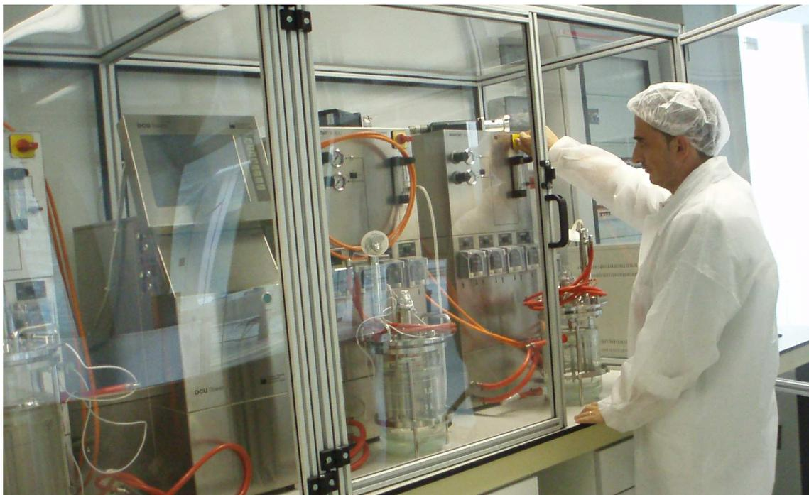
*Producción de PHB en bioreactores de 2L.*
