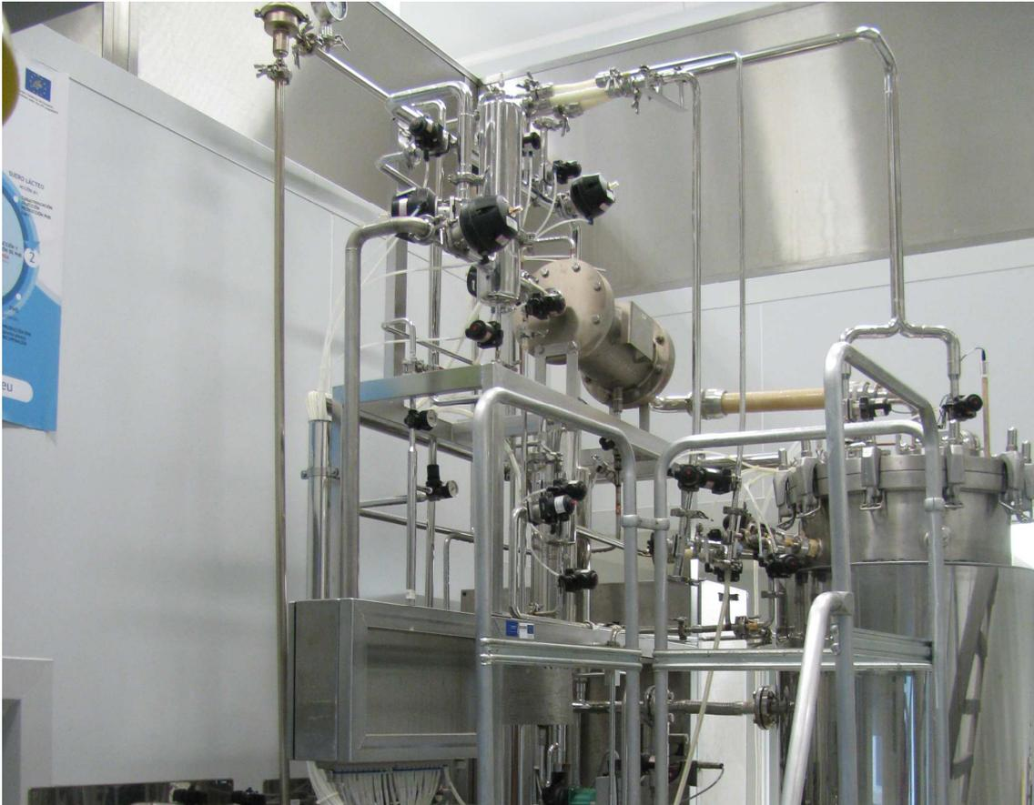
*Producción de PHB en bioreactor de 200L.*
